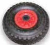
גליל פנאומטי בקוטר 250 מ"מ ג'נט עשוי פלסטיק מיסב מחט (ניתן לשליפה ולהחלפה בבוקסה)
